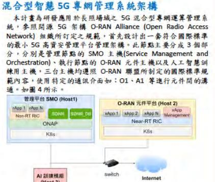
圖 4、混合型智慧 5G 專網管理系統架構圖
