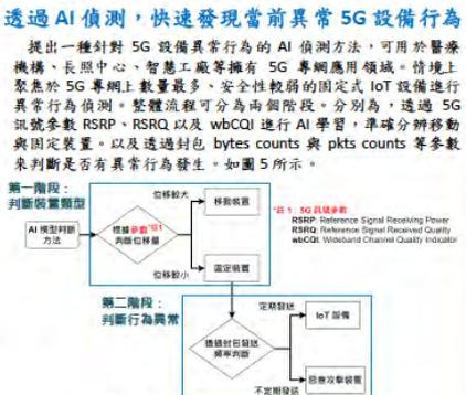
圖 5、兩階段檢測，找出異常固定式 IoT 設備
