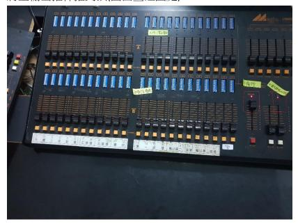
6. 燈光控制盤下方有標示所燈具投射位置
