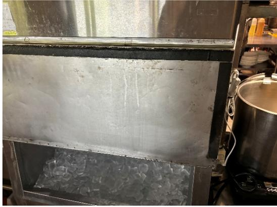
缺失：製冰機髒污與墊片破損，有交叉污染之虞。
