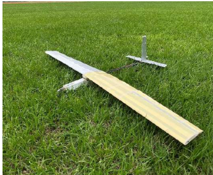
飛機完成品，最終重量在2.3公斤，測試動力飛行結束後拍攝
