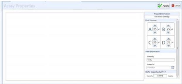
此視窗允許使用者在實驗結束後更改一些設定；於 Project Information 您可以更改當初設定的 Project Name · Project Number & PI 等資訊。進一步可點擊 Advance Settings · 重新設定藥物注入的體積 · 操作者姓名 · 操作日期與 Buffer Capacity。完成所有的設定後 · 請點選右上方的 Apply 完成設定 · 若不想套用此設定 · 請點擊 Cancel。
