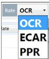
內建設定 X 軸為時間，Y 軸則為 Rate。可自由更改 Rate (OCR, ECAR)，點擊 Rate 的下拉式箭頭選單即可更改。
