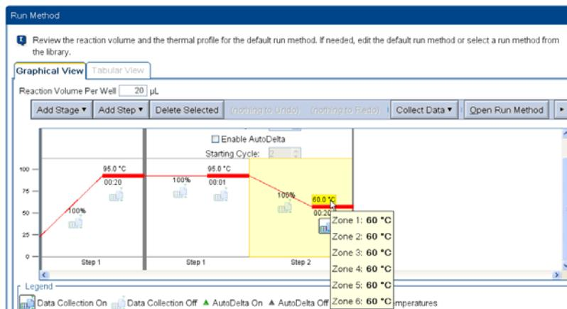
**Set different temperatures for one or more zones** 並設定每個區塊的溫度，請注意兩相鄰區塊溫度差異不可以超過 5 度，第一和第六區塊最多可差異 25 度。
