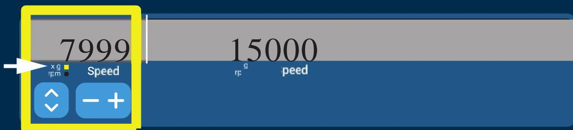
圖 4-2: 在RCF/rpm之間進行選擇並設置離心機速度
