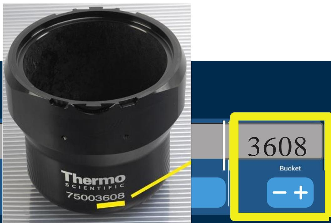
圖 4-8: 為轉子設置正確的吊籃代碼
