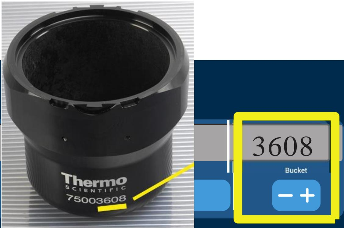
圖 2-15: 設置正確的吊籃代碼
