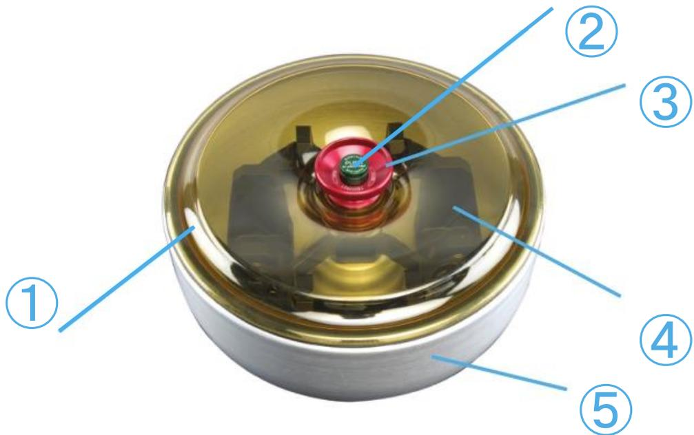
① 轉子蓋；② 自鎖按鈕；③ 轉子蓋把手；④ 擋風罩內吊籃的轉子橫穿螺栓；⑤ 擋風罩
