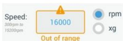
圖 3-62: 設置 -> 控制 -> 設定點螢幕：超出範圍值提示
