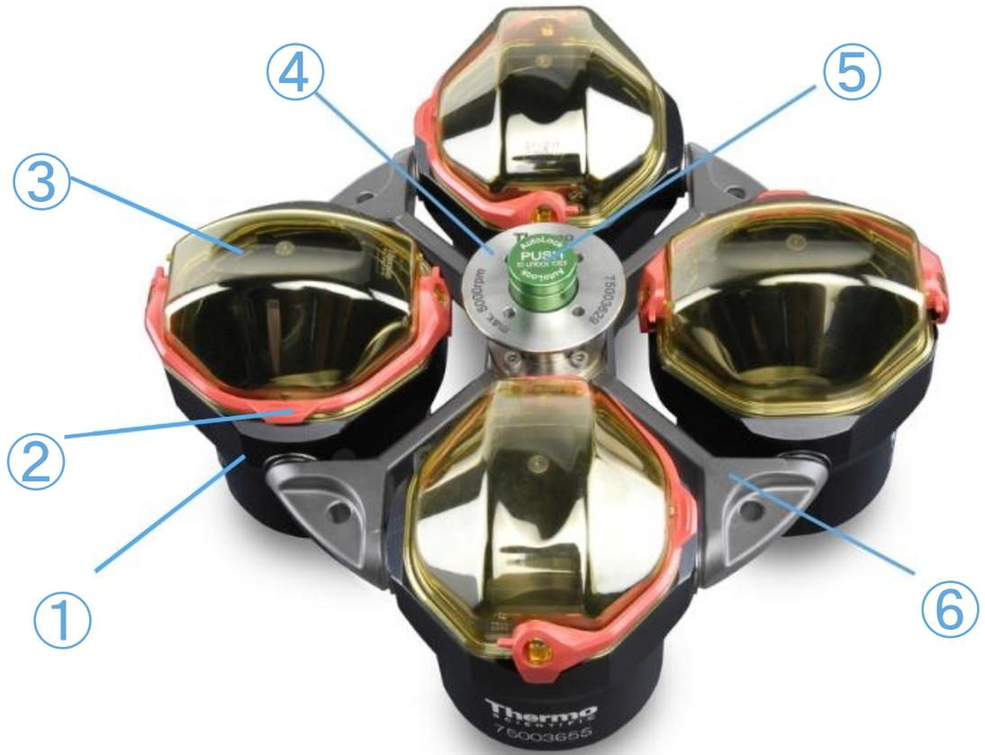
① 吊籃；② 蓋門；③ 吊籃蓋；④ 轉子旋鈕；⑤ 自鎖按鈕；⑥ 轉子橫穿螺栓
