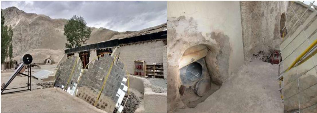
圖、兩塊聚光反射板(左)與光線聚集到鍋爐(右)
